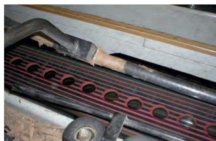
可使用QuickSplice快速拼接工具，现场对Pletex输送带进行热接。
